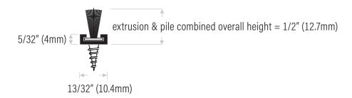
DS369A7545G Aluminum extrusion mill finish with fin pile insert, grey DS369A7445W with fin pile insert, white DS369A7145BL with fin pile insert, black
